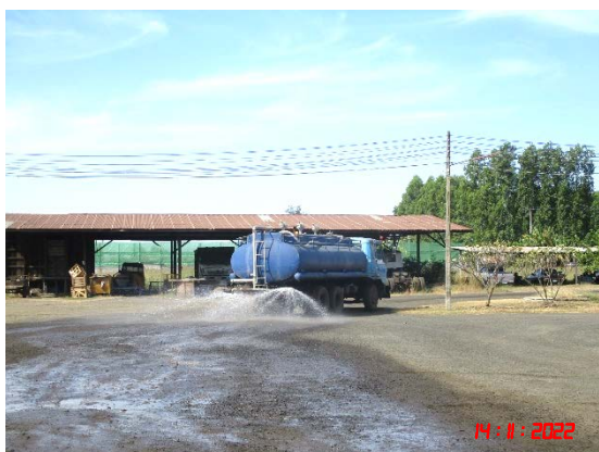
รูปที่ 23 การฉีดพรมน้ำเส้นทางขนส่งแร่
